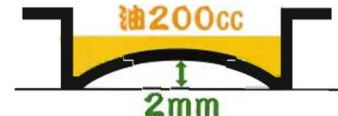
上記2点から、電磁調理器の温度センサーが正確に作動せず、油の温度が上昇したのがその理由です。
